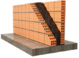
Parede Interior Enchimento de paredes duplas interiores com granulado de cortiça expandida
