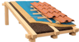
Cobertura Inclinada com isolamento entre vigas de madeira
