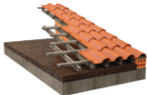
Cobertura Inclinada com isolamento sobre laje de esteira
