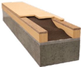
Laje e Pavimento Resiliência sobre soalho pregado sobre fibra de coco
