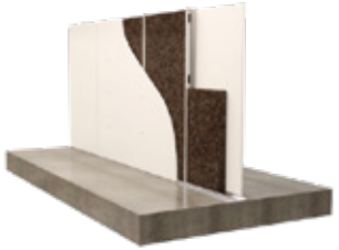
Parede Interior Divisória simples com isolamento
