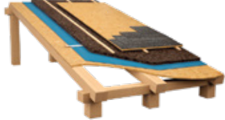
Cobertura Inclinada com isolamento sobre estrutura de madeira
