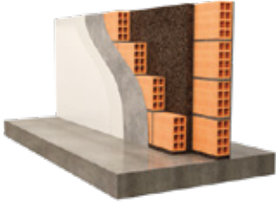
Parede Interior Dupla com isolamento preenchendo totalmente a caixa de ar
