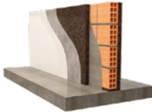
Parede Interior Divisória com isolamento bifacial
