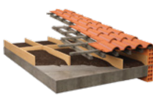
Cobertura Enchimento de caixas sobre laje esteira
