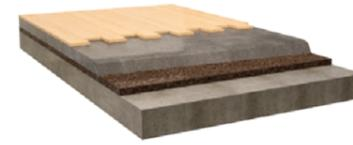
**Laje e Pavimento** Lajeta flutuante com revestimento mosaico
