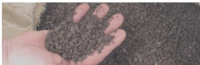
**Granulado de cortiça expandida.** Solução de enchimento leve com propriedades de isolamento acústico para aplicação em betonilhas, pavimentos e paredes duplas interiores.
