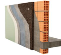
**Parede Exterior** Dupla com isolamento preenchendo parcialmente a caixa de ar
