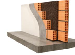
**Parede Interior** Divisória composta com isolamento
