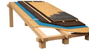
**Cobertura** Inclinada com isolamento em pendente
