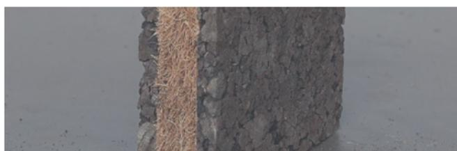
**Corkoco.** Solução que recorre a dois produtos naturais com características ímpares, a cortiça e o coco, garantindo alto desempenho no isolamento acústico. É especialmente vocacionada para aplicação em tectos, paredes e pavimentos.
