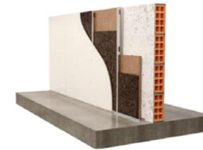
**Parede Interior** Divisória simples com isolamento
