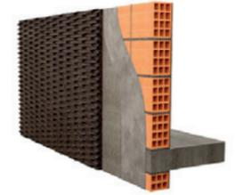
**Parede Exterior** Revestimento exterior à vista sobre isolamento
