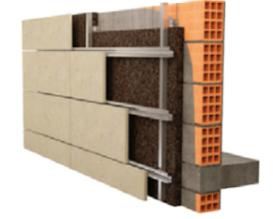
**Parede Exterior** Revestimento exterior à vista
