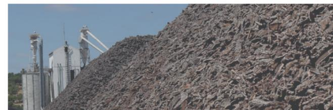
O aglomerado de cortiça expandido é produzido a partir da falca, um tipo de cortiça única que se extrai dos ramos das podas do sobreiro. Uma vez extraída é armazenada em fábrica.
