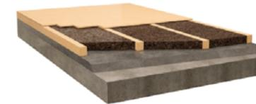
**Laje e Pavimento** Enchimento de caixa de soalho
