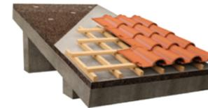
**Cobertura** Inclinada com isolamento sobre laje de esteira
