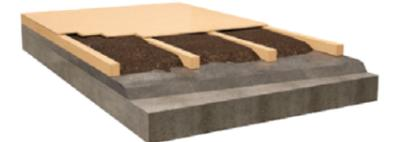
**Laje e Pavimento** Betonilha de enchimento (betão leve)
